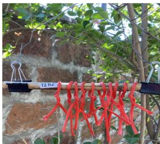
Figura 3. Instalación de emisores en grupo de 10, diseño asterisco o columpio.
