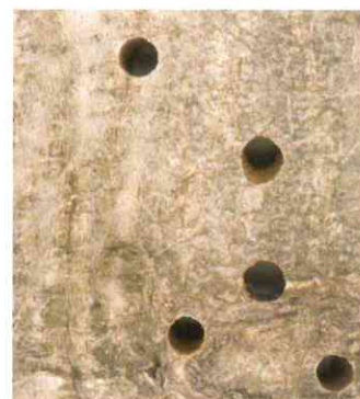
Figura 5: Orificios perfectamente circulares, de hasta 6 mm de diámetro, que corresponden al punto de salida de los adultos desde la madera.
