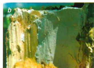
Figura 6: (a) Galerías en el interior de la madera formadas por las larvas al alimentarse. (b) En daños muy avanzados, se observa el micelio del hongo simbiote ( Cerrena unicolor (Bull) Murr.) y pudrición blanca.
