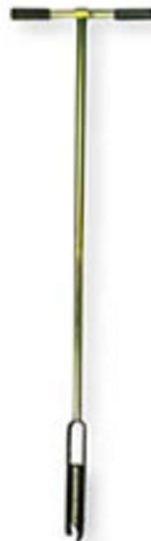
Figura A.4: EQUIPO DE MEUSTREO: BARRENO
